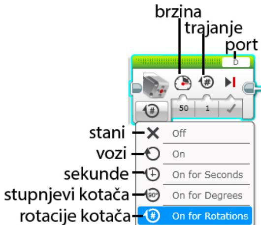
Dizanje olovke je predstavljeno okretanjem motora za djelić kruga. Stoga odabiremo postavku *On for degrees* i npr. 60 stupnjeva. Ne želimo da se olovka digne previše, već onoliko koliko je dovoljno da ne ostavlja trag. Brzinu postavljamo na 10 kako bi dizanje olovke bilo obavljeno što elegantnije. Čekanje od 1 sekunde na kraju je iz estetskih razloga.
